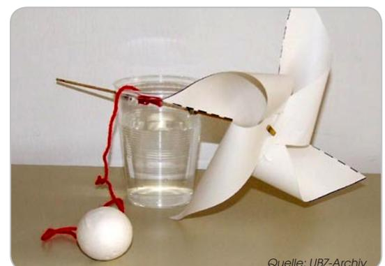
Mit der eigenen Puste oder mit einem Fön kann man nun das Windrad von vorne oder von der Seite antreiben - der Faden wickelt sich um den Spieß und das Gewicht (die Styroporkugel) wird angehoben. So lässt sich eine Möglichkeit zeigen, wie Windkraft direkt in Arbeit umgesetzt werden kann.
